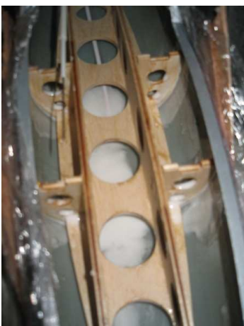
Collage à l'époxy et au micro ballon (la matière blanche...)
