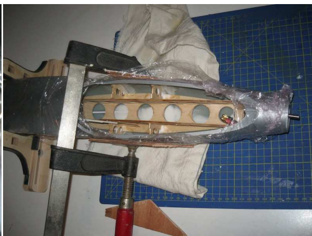
Collage à l'époxy et au micro ballon (la matière blanche...)
