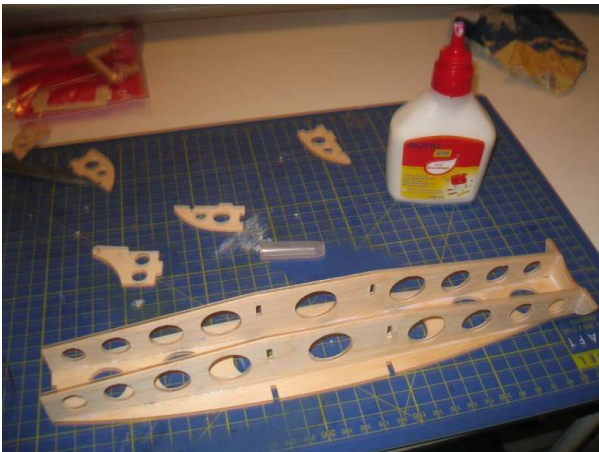
Collage à l'époxy et au micro ballon (la matière blanche...)
